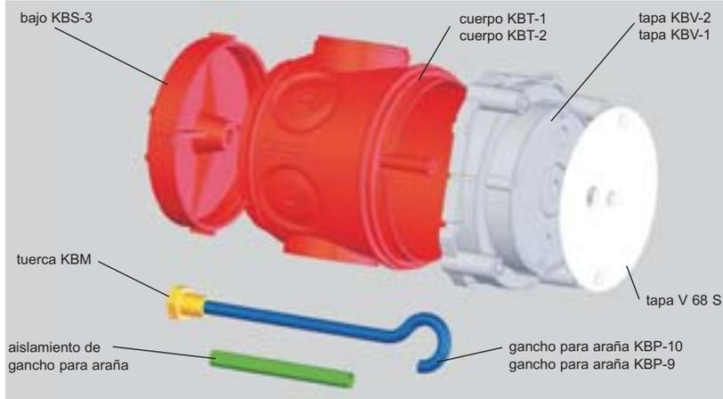
La tapa KBV-1 (KBV-2) se instala sobre la pieza fija horizontal del encofrado. Luego montamos el cuerpo KBT-1 (KBT-2) y junto con la pieza del bajo KBS-3 los introducimos en la tapa ya fijada.
